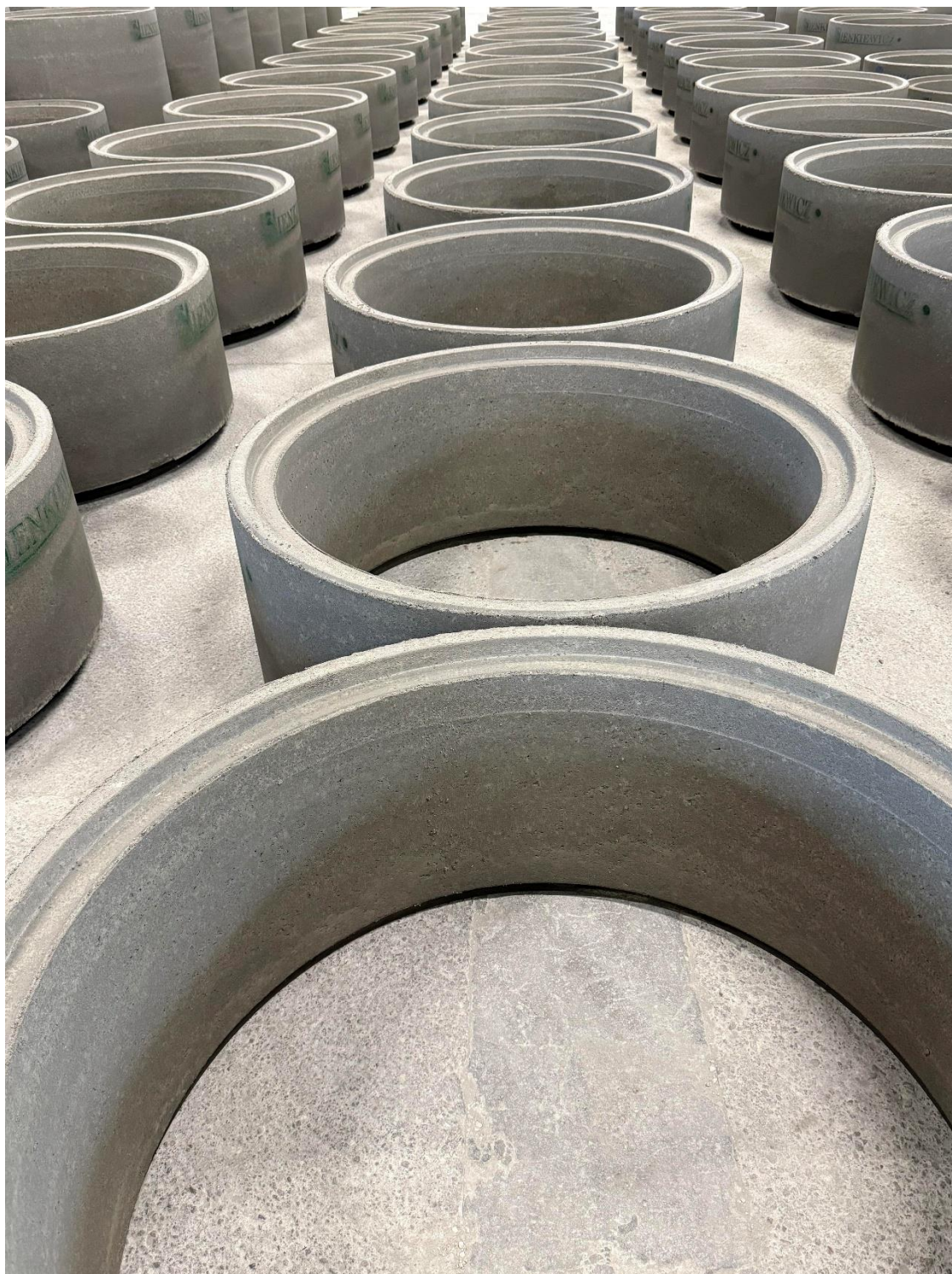
Rysunek 4.8: Wibroprasowane elementy studni TORNADO 2 - kręgi
